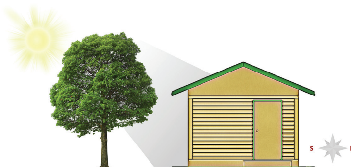
FIGURA 4.21 – Ensombramento do telhado para reduzir a incidência direta da radiação solar.
