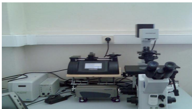
Figura 29 - Microscópio ligado a um sistema com bomba de seringa
