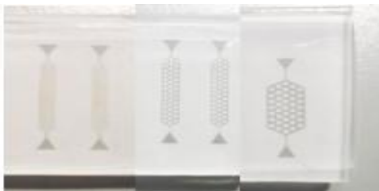
Figura 26 - Microcanais obtidos: Círculos com diâmetro 300 \mu\text{m} ; 600 \mu\text{m} e com diâmetro 800 \mu\text{m} .
