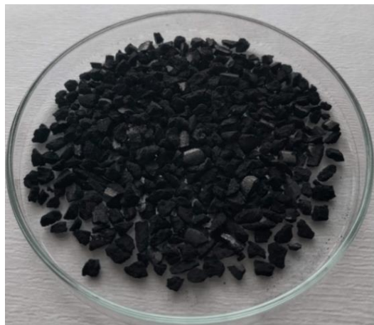
Figura 3 - Carvão ou bio-char da pirólise (Steltenpohl et al, 2019).
