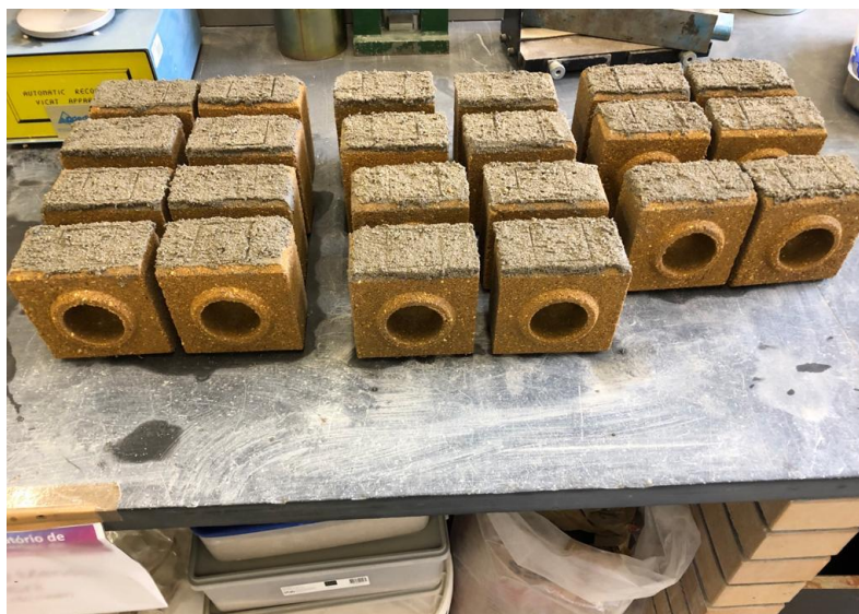
Figura 40- Meio-blocos com chapisco
