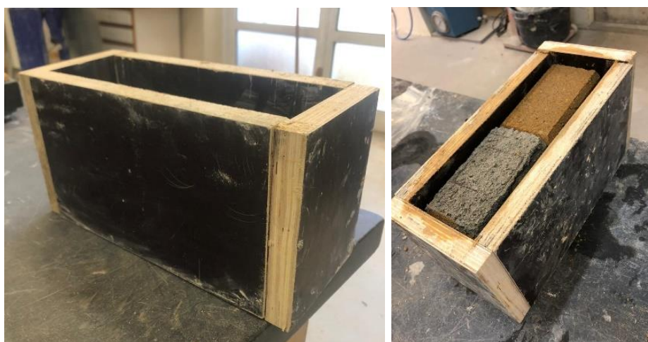
Figura 41- Molde para a aplicação da argamassa para o ensaio de aderência bloco-argamassa
