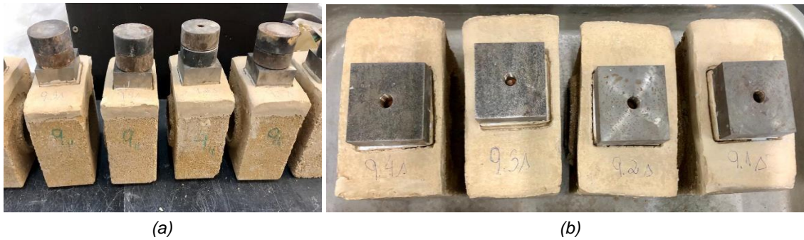
Figura 50- Ensaio Pull-Off: (a) preparação dos provetes, (b) provetes com as peças metálicas 50x50 mm
