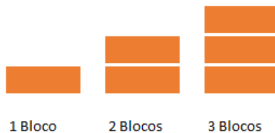
Figura 25- Esquema para o ensaio para verificação do efeito de confinamento dos blocos
