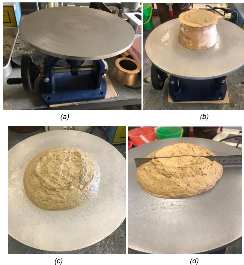
Figura 37- Etapas do ensaio de consistência por Flow Table : (a) equipamento; (b) argamassa no molde tronco-cônico; (c) após 15 pancadas da mesa e (d) medição do diâmetro de espalhamento
