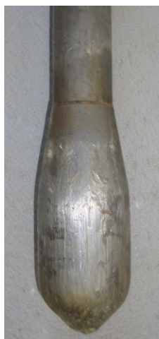
Figura 4 – Vara e ponteira usada no DPSH
