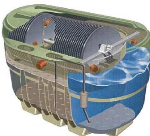
Figura 11 - ETAR compacta com tratamento por biodiscos (Nascimento et al. , 2011).
