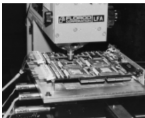
Figura 3.11 - Infra-estrutura de injeção de faltas baseadas na técnica de radiação LASER.
