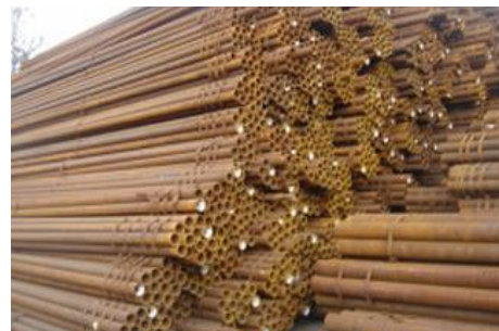
Figura 48 - Perfis metálicos (tubo API N80) (13).
