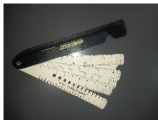
a) - Régua de fissuras.
