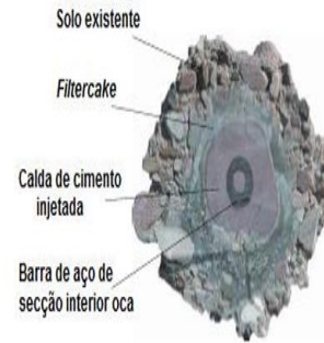
Figura 42 - Secção final da micro-estaca (14).
