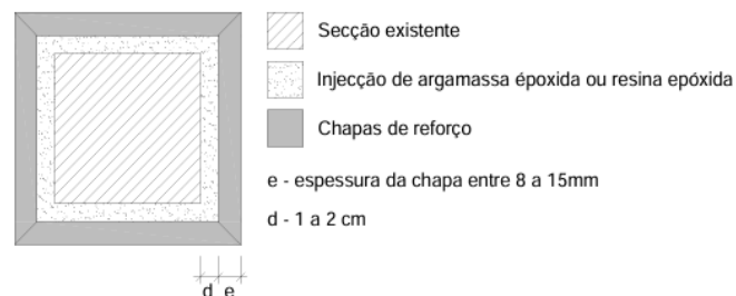
Figura 71 - Sistema base de encamisamento de pilares com chapas metálicas (17).
