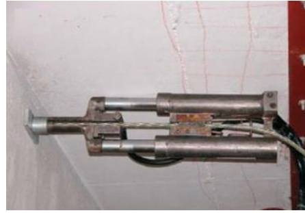
Figura 112 - Pormenor do macaco hidráulico (22).
