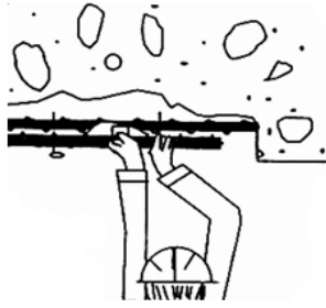
Figura 61 - Substituição de varões danificados (12).
