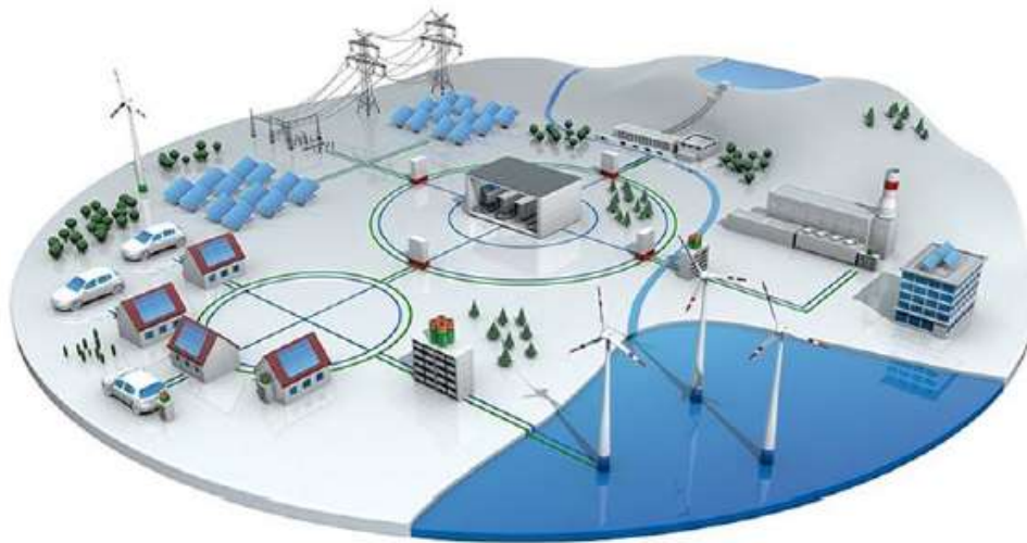
Figura 3 - Esquema de uma rede inteligente (Rivera, Teixeira, & Esposito, 2013).
