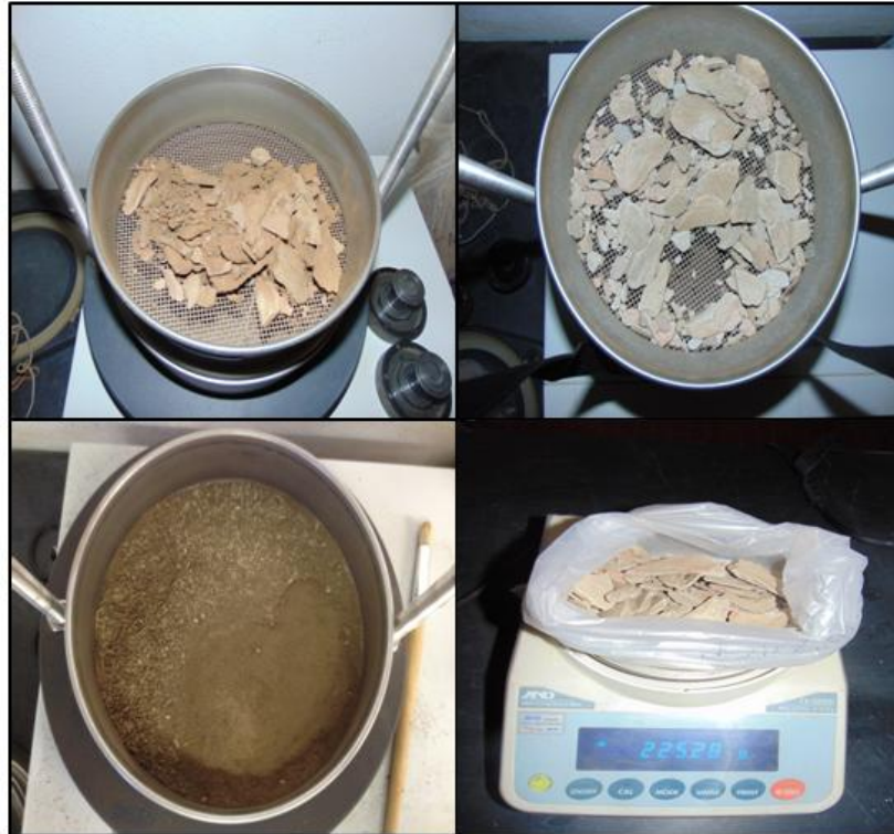
Figura 14 - Processo de separação das frações elementos grosseiros e terra fina das amostras de solo.
