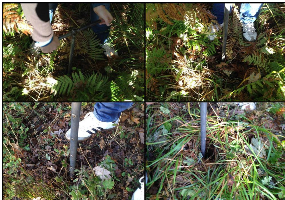
Figura 16 - Medições da profundidade do solo, no solo climácico.
