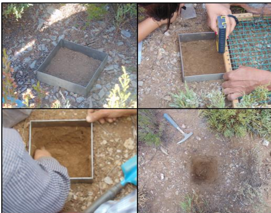
Figura 12 - Recolha de amostras de solo e medição da profundidade das camadas.
