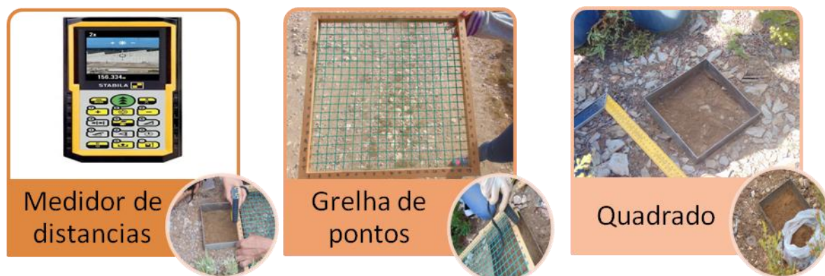
Figura 11 - Materiais usados na recolha de amostras de solo no campo.
