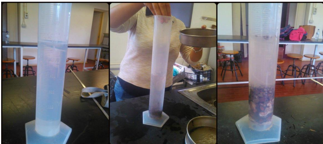
Figura 15 -Determinação do volume dos elementos grosseiros.
