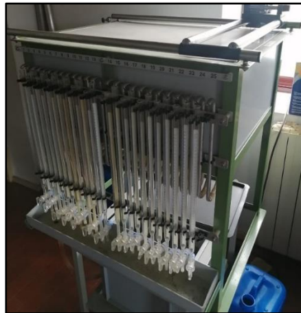
Figura 15: Permeômetro de circuito fechado e carga constante
