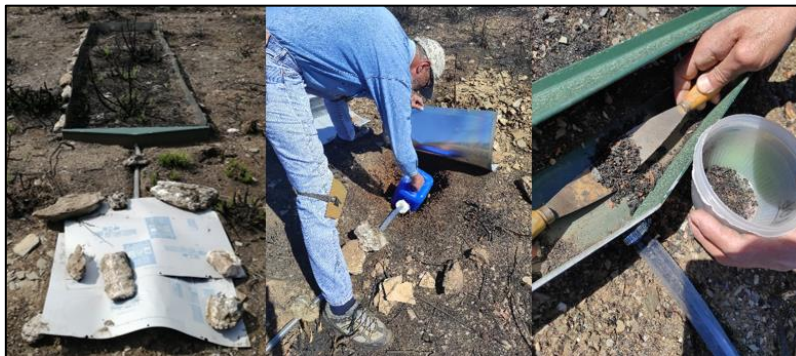
Figura 13: Recolha do escoamento superficial e de solo por erosão
