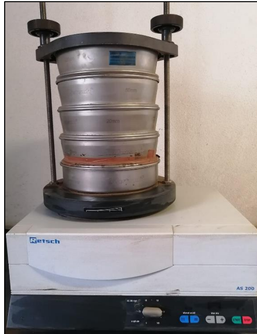
Figura 14: Equipamento para a determinação do teor de elementos grosseiros.
