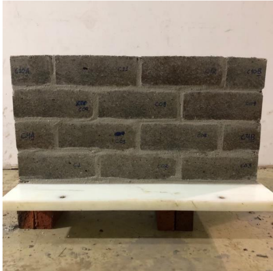
(a) Assentamento das 4 primeiras fiadas de um provete de alvenaria
