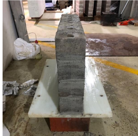
(a) Assentamento das 4 primeiras fiadas de um provete de alvenaria
