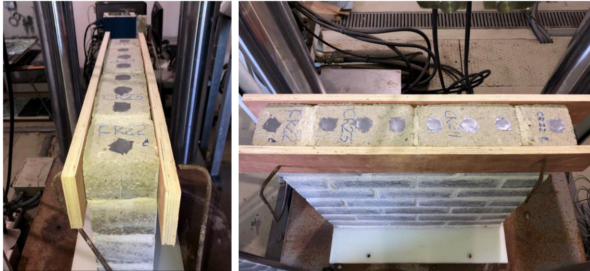
(a) Fechamento dos furos verticais e nivelamento das tábuas de madeira.
