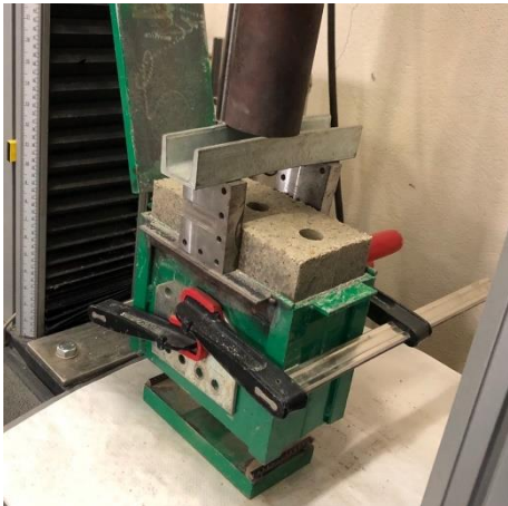
(e) Desmolde do bloco em andamento
