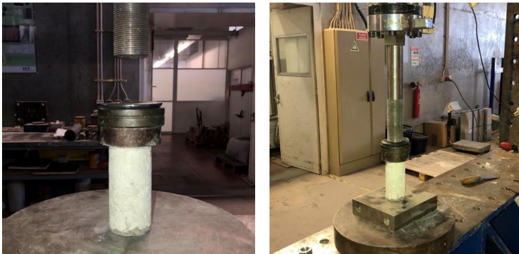
Figura 32 – Ensaio de compressão de um provete de argamassa. Fonte: Autoria própria.
