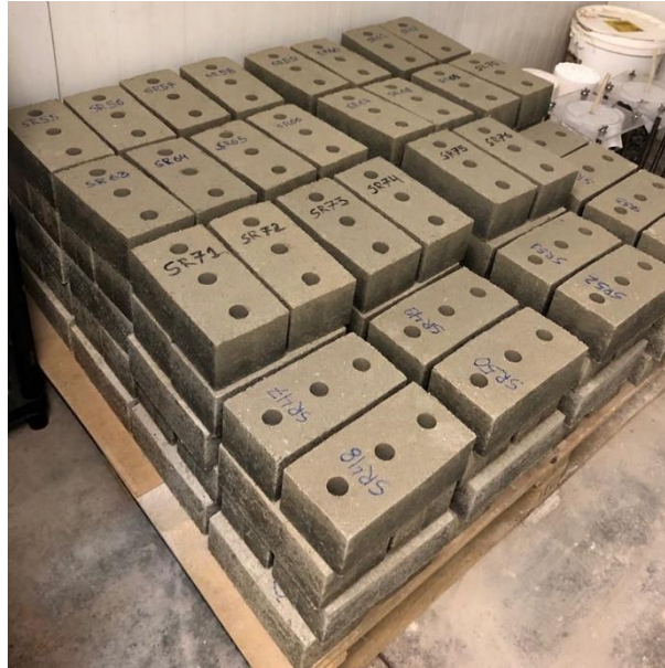
Figura 17 – Blocos de solo-cimento em câmara húmida Fonte: Autoria própria.
