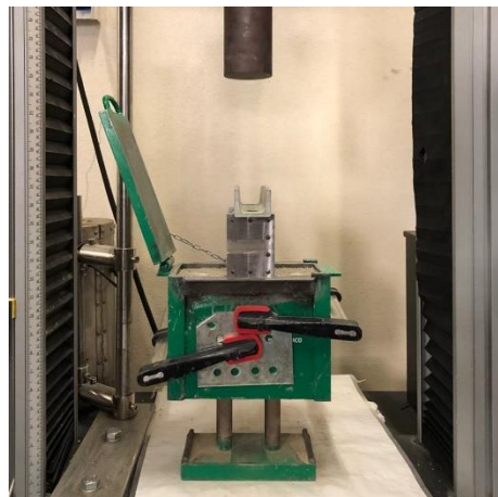
(d) Preparação para desmolde do bloco
