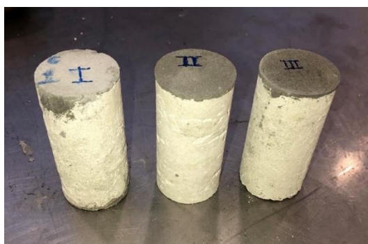
Figura 31 – Retificação de topo dos cilindros de argamassa.
