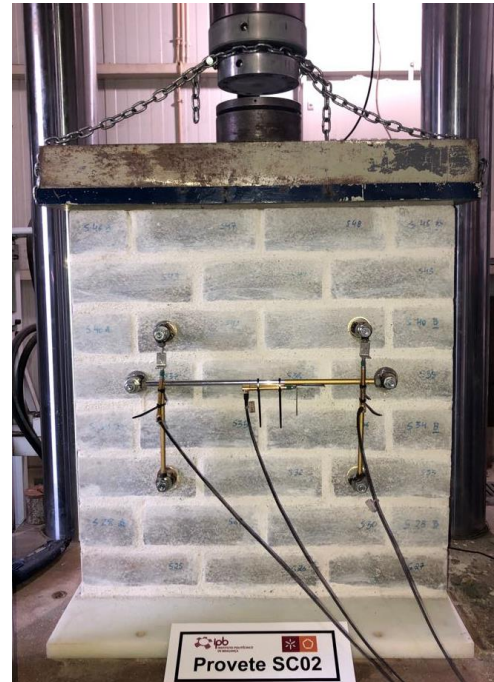
Figura 30 – Provete de alvenaria pronto para ser ensaiado. Fonte: Autoria própria.
