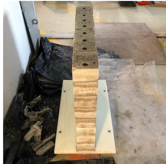
(b) Assentamento das 4 fiadas superiores do mesmo provete de alvenaria.
