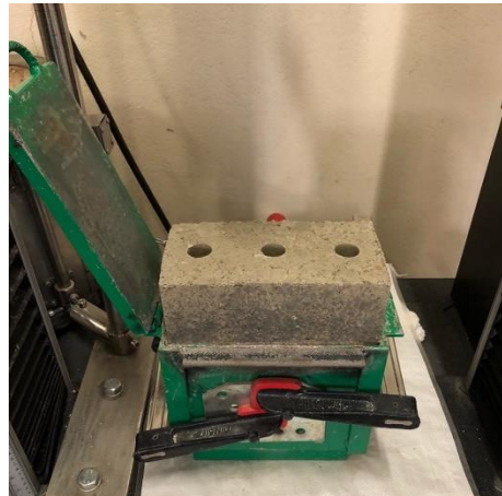
(f) Bloco recém desmoldado
