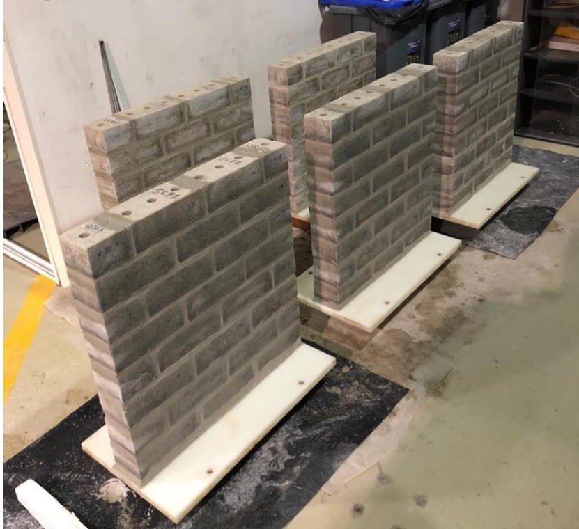
Figura 26 – Aspetto final dos demais provetes de alvenaria. Fonte: Autoria própria.
