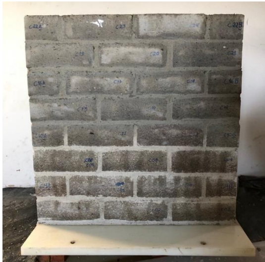
(b) Assentamento das 4 fiadas superiores do mesmo provete de alvenaria.
