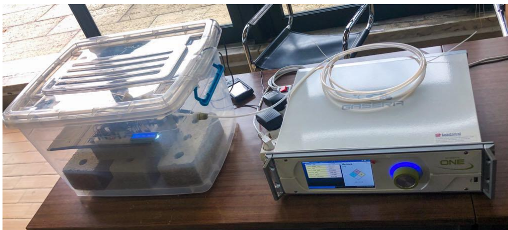
(c) Esquema de ensaio: Gasera One Pulse acoplada a caixa com os blocos.
