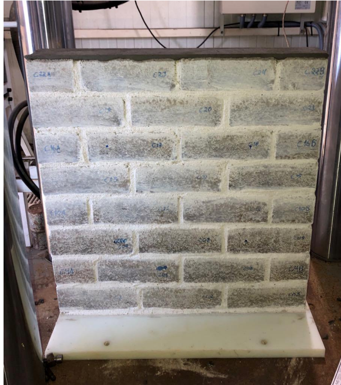
Figura 28 – Alvenaria já regularizada e centralizada no pórtilo de ensaio. Fonte: Autoria própria
