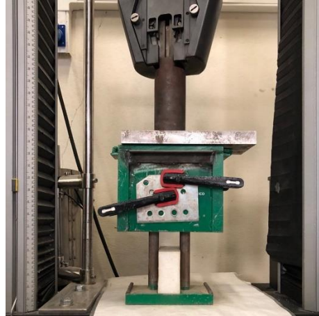
(b) Início da compactação do bloco
