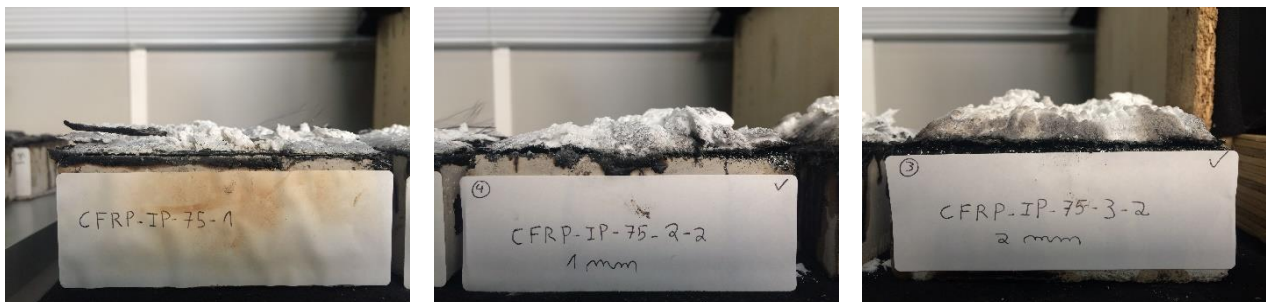
Figura 15 – Provetes reforçados com manta de CFRP e protegidos com tinta intumescente, sujeitos a um fluxo de calor de 75 kW/m 2
