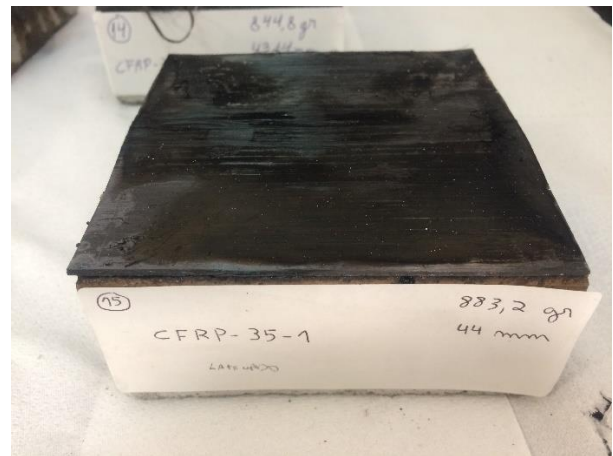
Figura 6 – Provetes reforçados com laminado de CFRP, para um fluxo de calor de 35 kW/m 2
