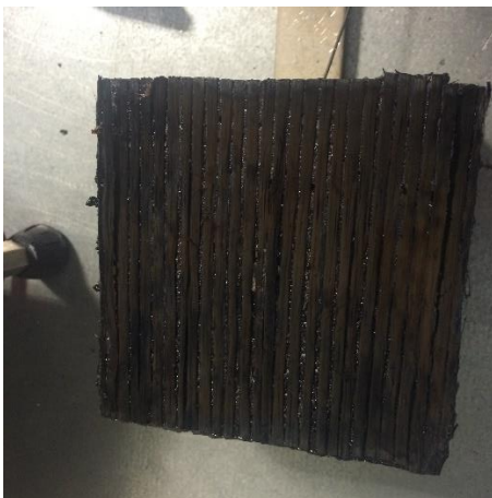
Figura 5 – Provetes reforçados com mantas de CFRP, para um fluxo de calor de 35 kW/m 2
