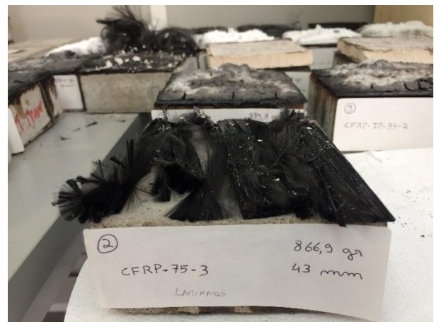
Figura 8 – Provetes reforçados com laminado de CFRP, para um fluxo de calor de 75 kW/m 2
