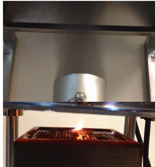
Figura 4 – Comportamento dos provetes de CFRP sem proteção
