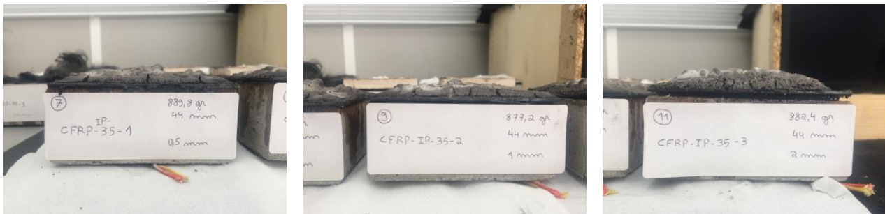
Figura 14 – Provetes reforçados com laminado de CFRP e protegidos com tinta intumescente, sujeitos a um fluxo de calor de 35 kW/m 2
