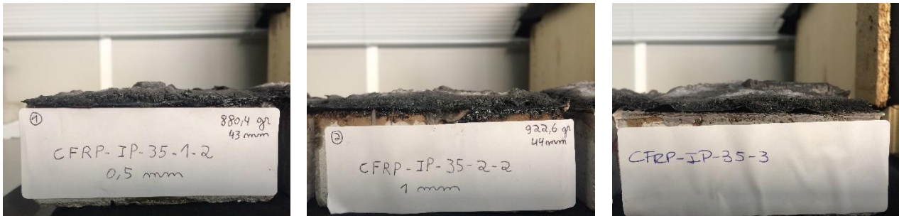
Figura 13 – Provetes reforçados com manta de CFRP e protegidos com tinta intumescente, sujeitos a um fluxo de calor de 35 kW/m 2
