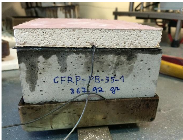
Figura 2 – Provetes protegidos com placa gesso
