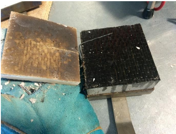
Figura 9 – Provedor reforçado com mantas de CFRP e protegido com placa de gesso, sujeito a um fluxo de calor de 35 kW/m 2
