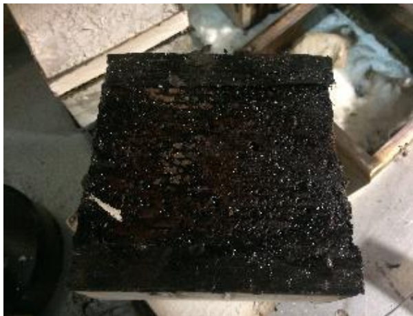
Figura 11 – Provedor reforçado com mantas de CFRP, e protegido com placa de gesso, sujeito a um fluxo de calor de 75 kW/m 2
