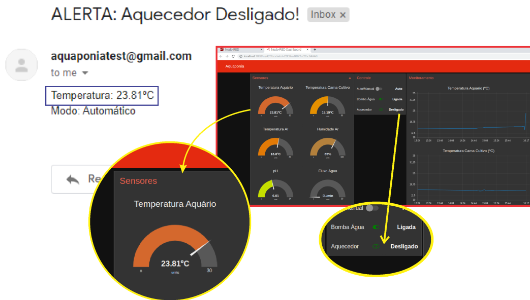
Figura 5.3: Fotografia das telas de notificação e do painel de visualização.
