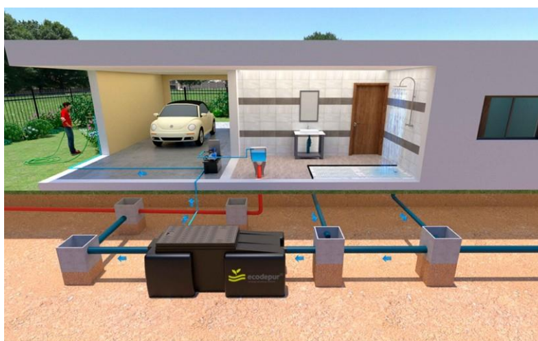
Figura 11 – Exemplo esquemático de um SPRAC (ECODEPUR, s.d).
