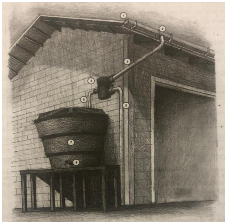
Figura 12 – Sistema de captação, armazenamento e aproveitamento de águas pluviais (SILVA, 2015).
