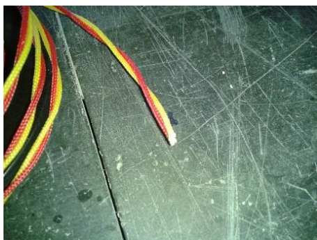
Figura 23 – Termopares do tipo I (T1)
