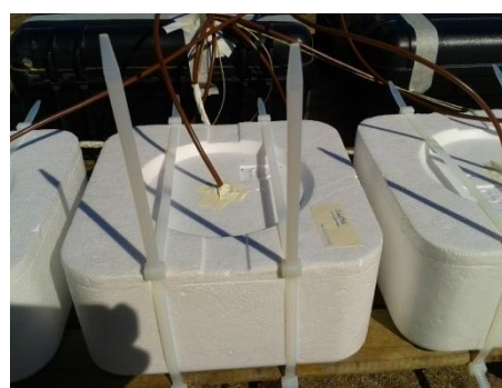
Figura 31 - Termopar - ar interior
