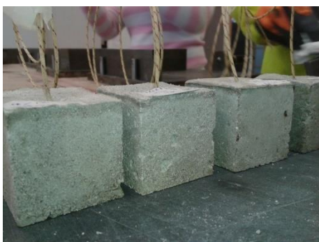
Figura 27 - Provetes com PCM-octadecano
