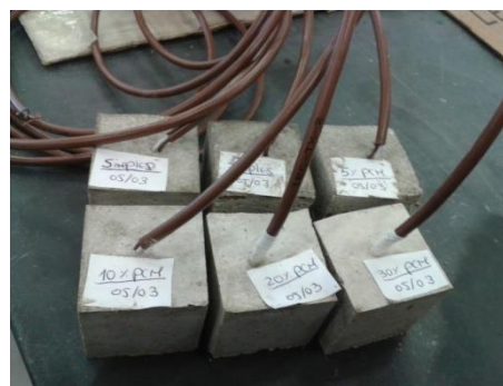
Figura 28 - Provetes com PCM-parafina
