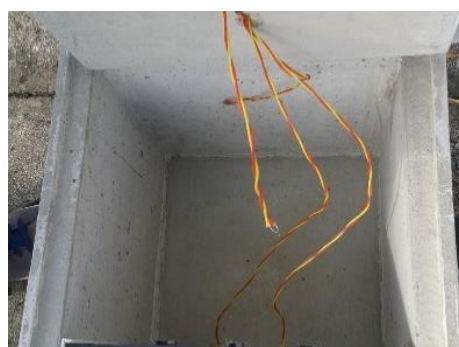
Figura 35 – Posicionamento dos 3 termopares
