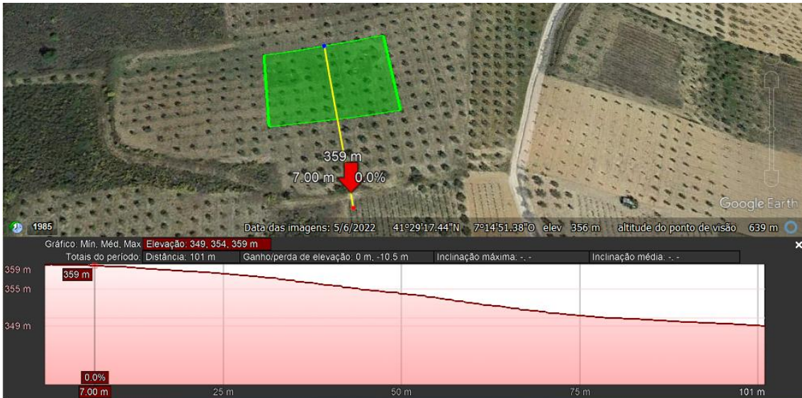
Figura 32- Ponto dois, referente a distância percorrida da maior altitude encontrada na área não mobilizada até o ultimo transecto (T7), para obtenção da declividade da área, (Google Earth, 2023).
