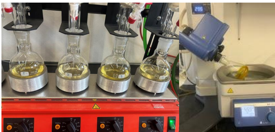
Figura 14. Extração do óleo de trigo através do soxhlet e utilização do roto-evaporador para evaporação do solvente
