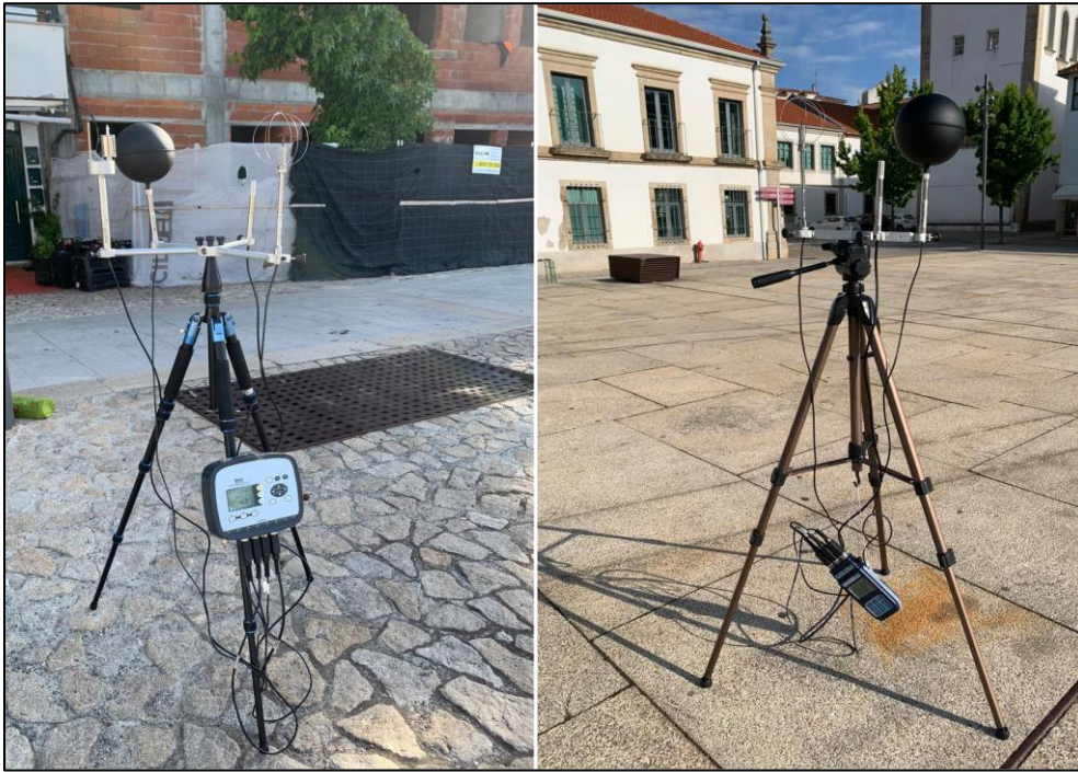
Figura 3.4 - Registradores de dados de microclima térmico – Datalogger, Delta Ohm 32.1 (Esquerda) e Delta Ohm 32.3 (Direita).
