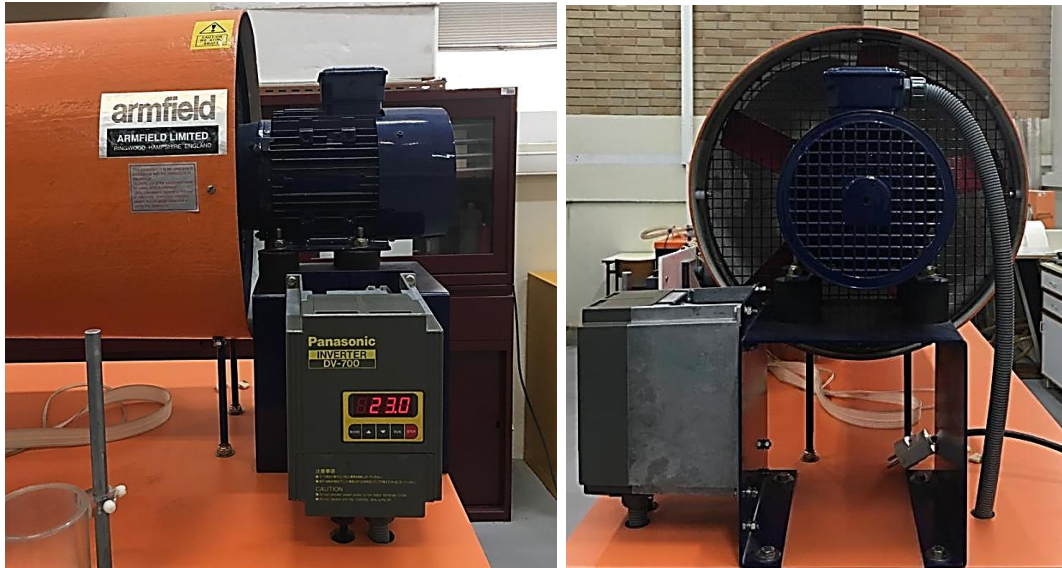
Figura 20. Inversor de frequências do sistema de propulsão.
