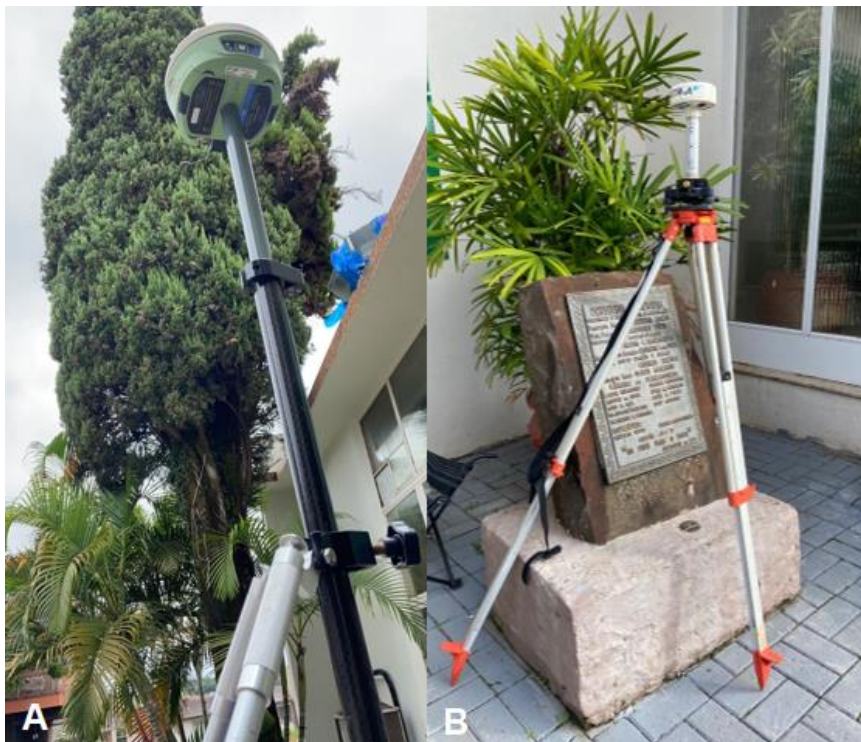
Figura 17 – Obstruções entorno da estação 96153, (A) Árvores arredores (B) Monumento e edificação próximos ao receptor GNSS. Fonte: A autora (2021).
