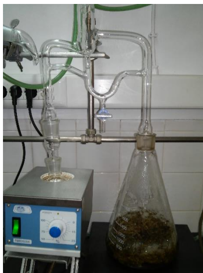
Figura 16 - Destilação-extração Likens-Nickerson de Thymus zygis L. subsp.. zygis .
