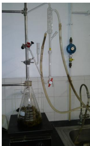
Figura 17 - Destilação com recurso a um Clevenger de Thymus zygis L. subsp.. zygis .
