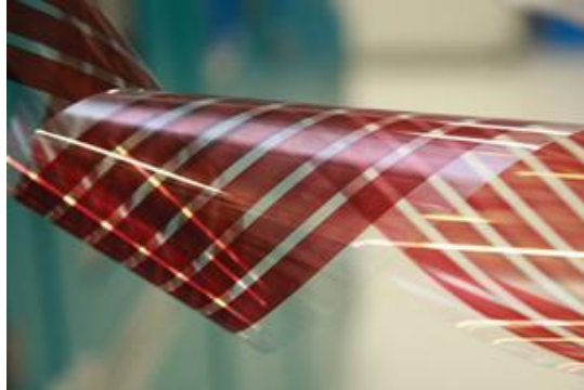
Figura 7: painel solar fotovoltaico orgânico (OPV) [8].
