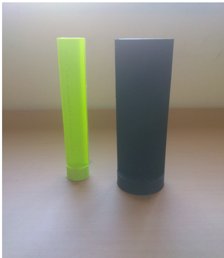
Figura 3.23: Diferença entre os dois tipos de pás impressas. À esquerda, um exemplo das pás com 2 cm de corda. À direita encontra-se uma das pás com a correção para 4 cm de corda.
