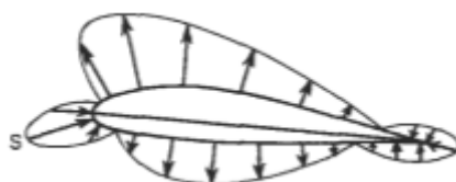
Figura 3.18: Distribuição da pressão para o ângulo de ataque = 6^\circ (Houghton & Carpenter (2005)).
