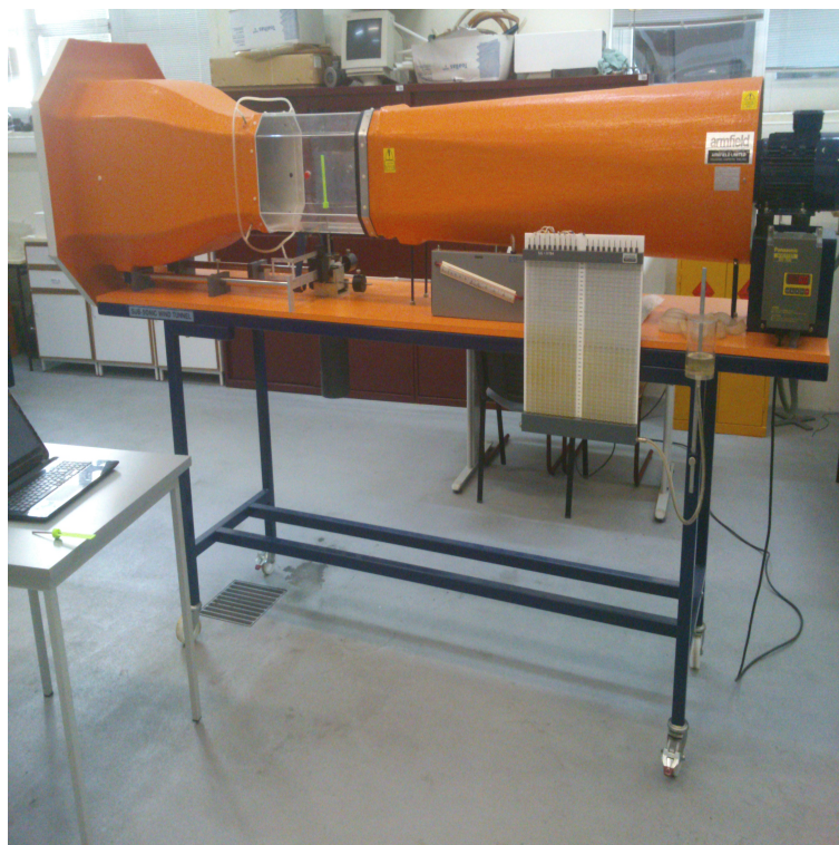
Figura 3.2: Túnel aerodinâmico subsônico da Armfield , modelo C2.
