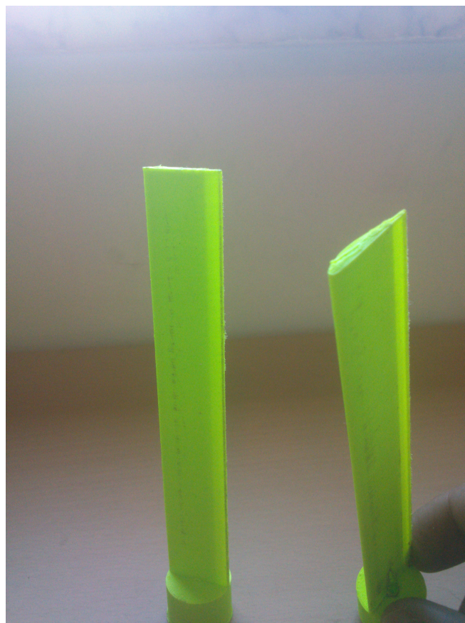
Figura 3.15: Pás impressas com os perfis NACA 2414 e NACA 4415, respectivamente.
