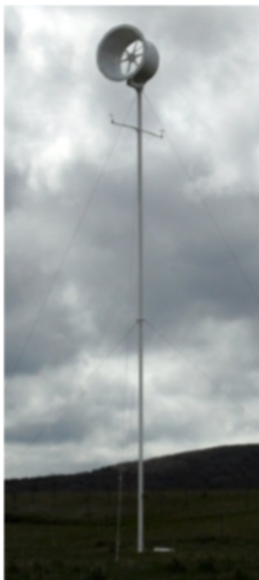
Figura 1.4: Protótipo Enhanced WT testado a 12 metros de altura, num ambiente livre de construções (Maia (2014)).
