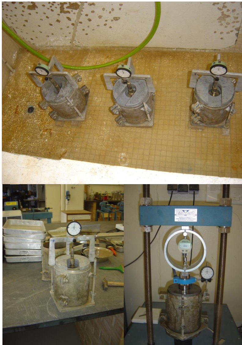
Figura 3-3 - Realização do ensaio CBR.
