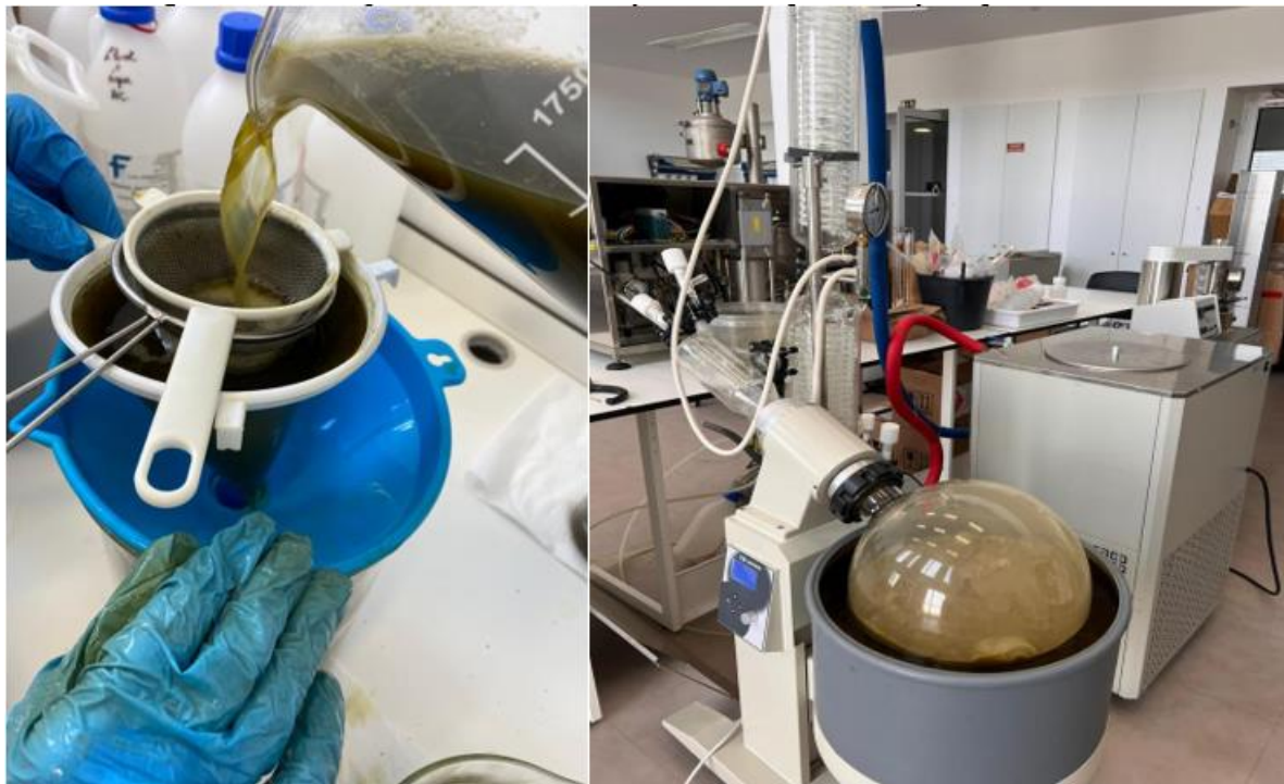
Figura 17 - Filtração das amostras após a extração e evaporação do etanol.
