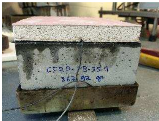
Figura 29- Termopar na face inferior da placa de gesso.
