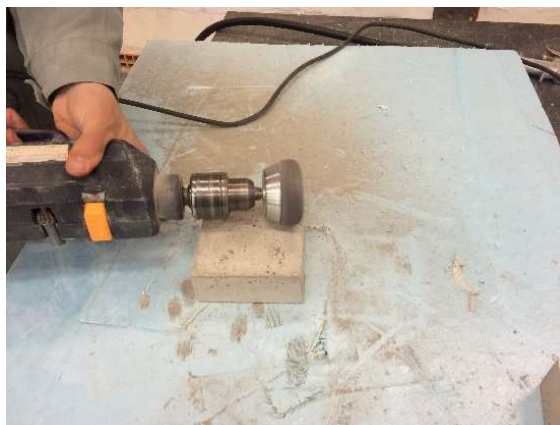
Figura 9 – Polimento da superfície de betão.
