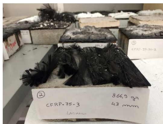
Figura 28 – Provetes reforçados com laminado de CFRP, para um fluxo de calor de 75 [kW/m 2 ].
