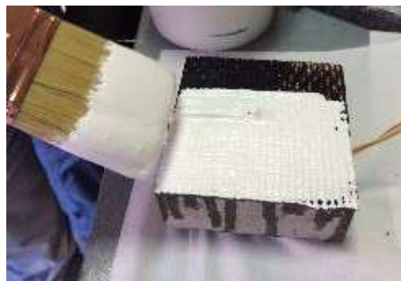
Figura 18 – Aplicação da tinta com trincha.
