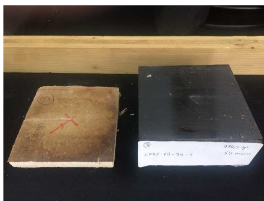
Figura 31 – Provete reforçado com laminado de CFRP e protegido com placa de gesso, sujeito a fluxo de calor de 35 [kW/m 2 ].
