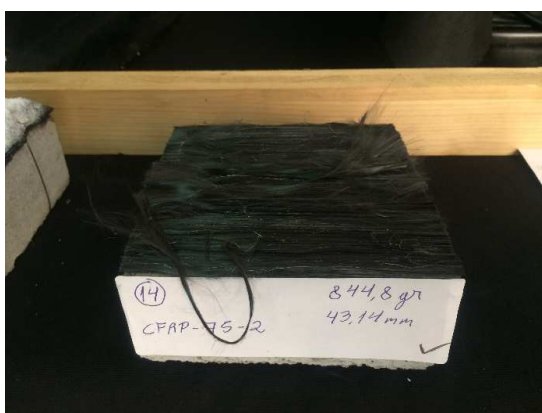
Figura 27 – Provetes reforçados com mantas de CFRP, para um fluxo de calor de 75 [kW/m 2 ].
