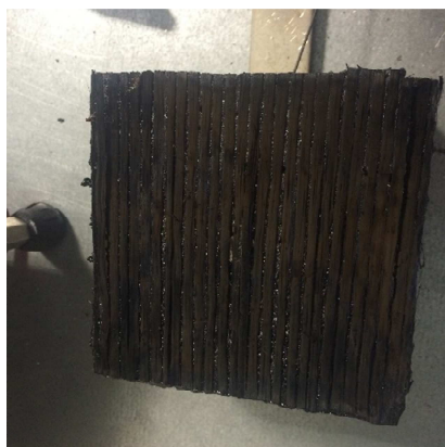
Figura 25 – Provetes reforçados com mantas de CFRP, para um fluxo de calor de 35 [kW/m 2 ].
