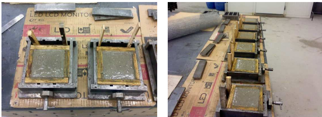
Figura 7 – Moldes de betão.
