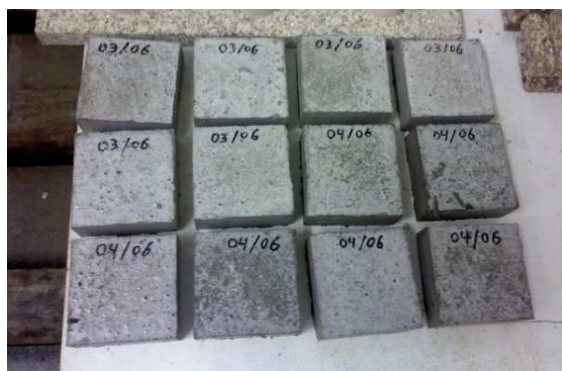
Figura 8 – Provetes de betão.
