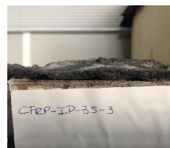
Figura 36 – Provetes reforçados com manta de CFRP e protegidos com tinta intumescente, sujeitos a um fluxo de calor de 35 [kW/m 2 ].
