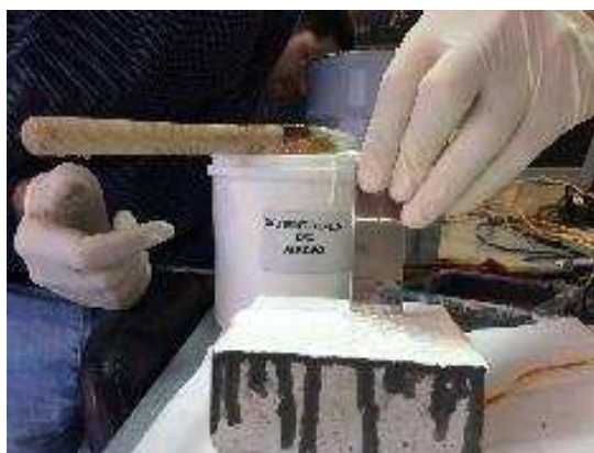
Figura 19 – Espessura da tinta intumescente.
