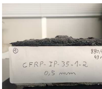
Figura 36 – Provetes reforçados com manta de CFRP e protegidos com tinta intumescente, sujeitos a um fluxo de calor de 35 [kW/m 2 ].
