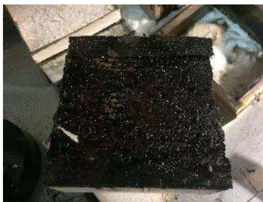
Figura 32 – Provete reforçado com mantas de CFRP, e protegido com placa de gesso, sujeito a um fluxo de calor de 75 [kW/m 2 ].
