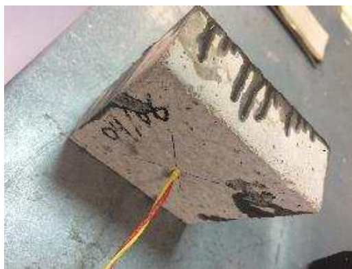
Figura 22- Termopar do tipo K introduzido na base inferior do provete de betão.
