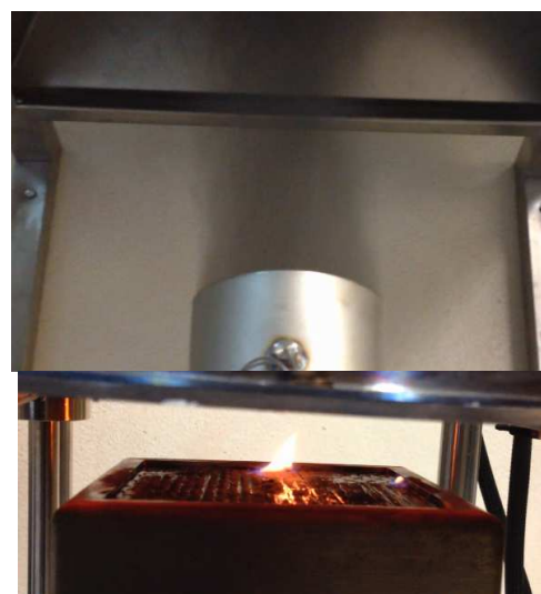
Figura 24 – Extinção da chama e libertação de fumo.
