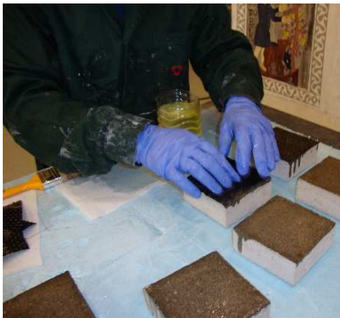
Figura 13 – Colagem da manta.
