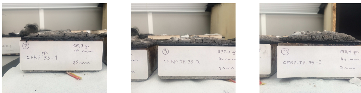
Figura 37 – Provetes reforçados com laminado de CFRP e protegidos com tinta intumescente, sujeitos a um fluxo de calor de 35 [kW/m 2 ].
