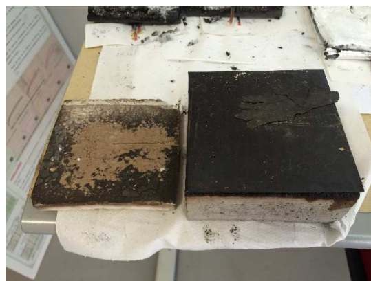
Figura 33 – Provete reforçado com laminado de CFRP e protegido com placa de gesso, sujeito a um fluxo de calor de 75 [kW/m 2 ].
