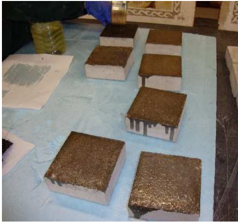
Figura 11 – 1ª demão de resina no provete.
