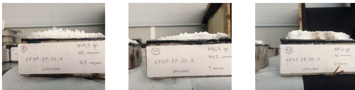
Figura 39 – Provetes reforçados com laminado de CFRP e protegidos com tinta intumescente, sujeitos a um fluxo de calor de 75 [kW/m 2 ].
