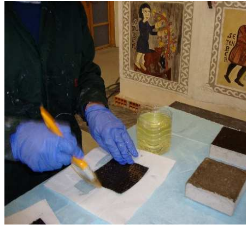
Figura 12 – Aplicação da resina na manta de CFRP.
