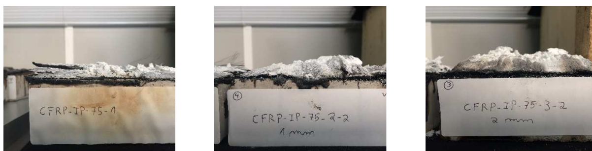
Figura 38 – Provetes reforçados com manta de CFRP e protegidos com tinta intumescente, sujeitos a um fluxo de calor de 75 [kW/m 2 ].
