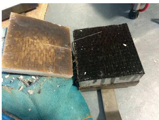
Figura 30 – Provete reforçado com mantas de CFRP e protegido com placa de gesso, sujeito a um fluxo de calor de 35 [kW/m 2 ].
