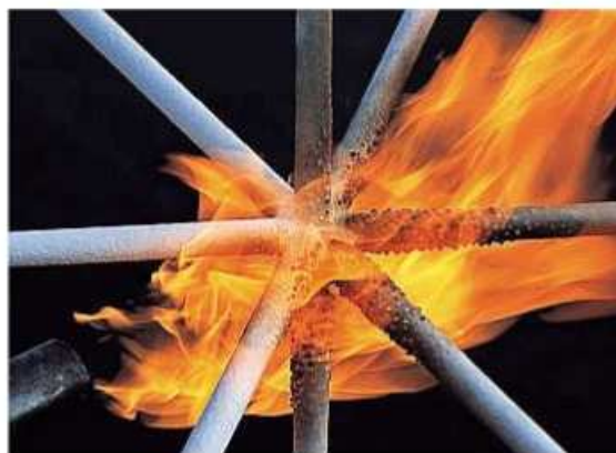
Figura 4- Tinta intumescente sob ação do fogo.
