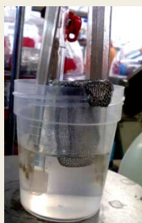
Fig. 2 - Recipiente com meio de dissolução e suporte para medicamento
