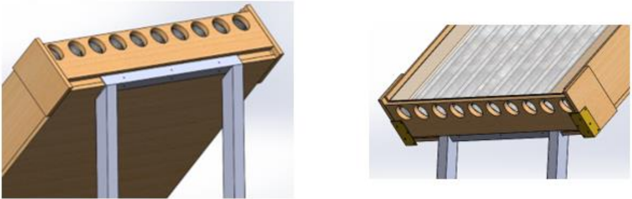
Figura 50 - Detalhe solda de apoio superior e inferior
