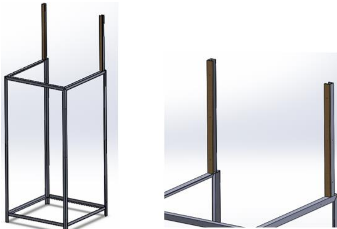
Figura 36 – Esquerda -estrutura com chaminé; Direita- detalhe da chaminé
