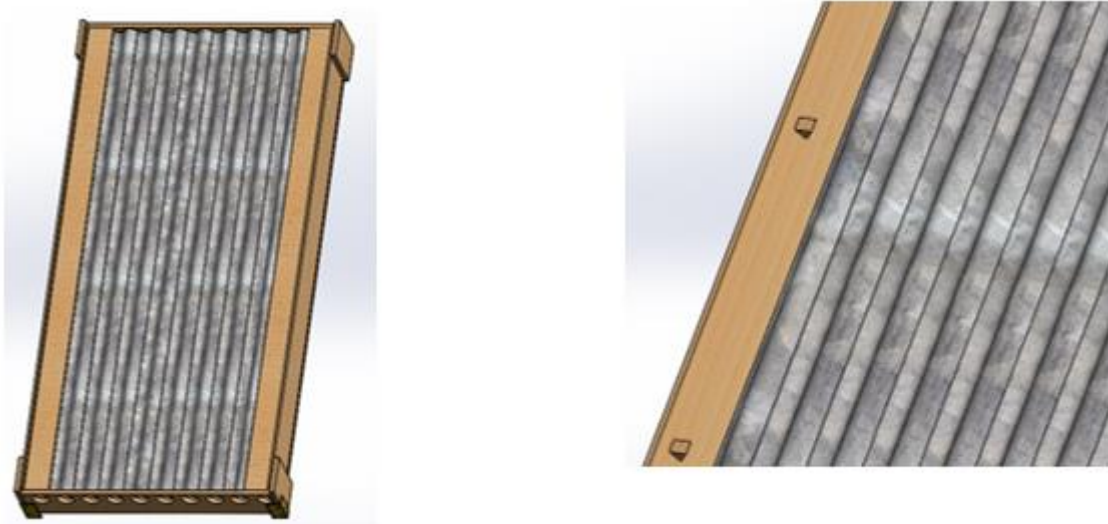
Figura 46 - Esquerda- estrutura com apoio de acrílico; Direita- detalhe dos fixadores dos apoios
