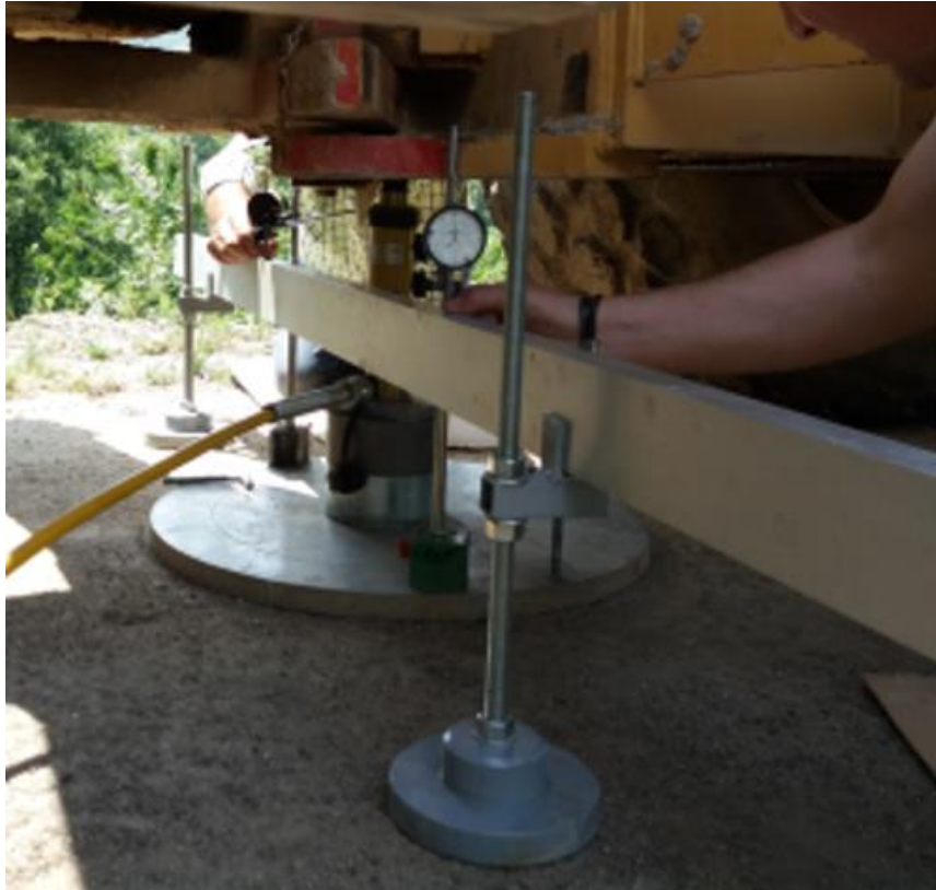
Figura 20- Ensaio de Carga em Placa
