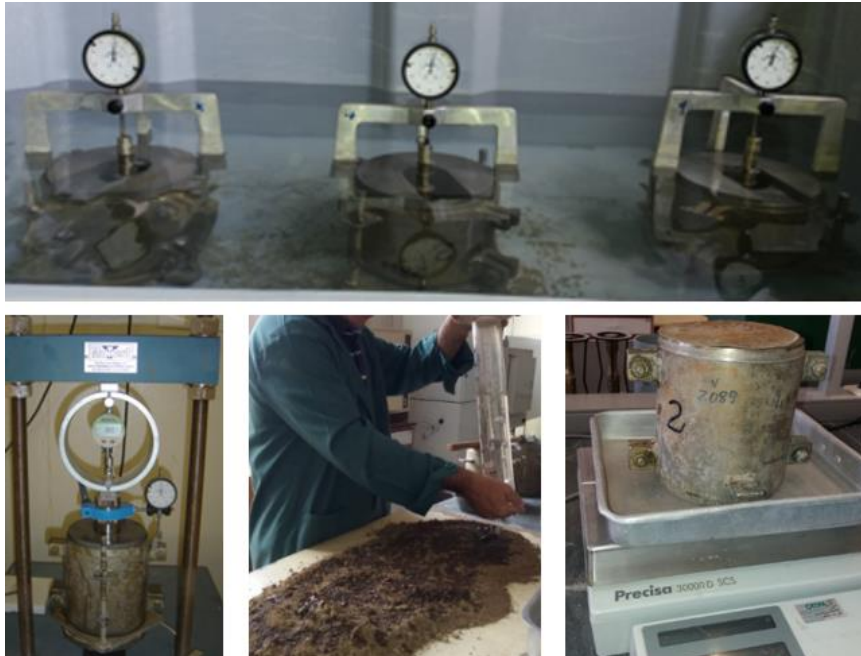
Figura 14- Realização do ensaio CBR
