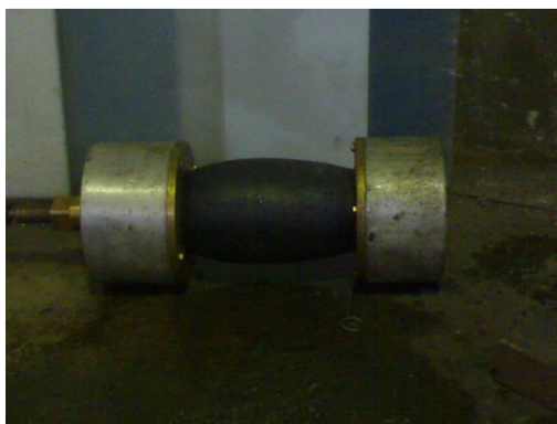
Fig.16- Ensaio de pressão para tubo PE 63
