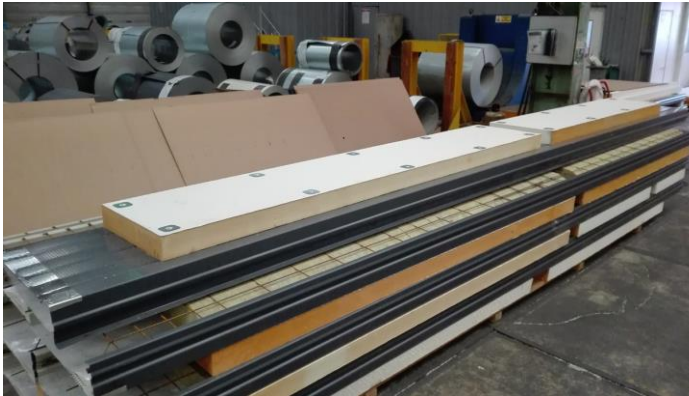
Fig. 1: Laje ARCELOR utilizada no ensaio.
